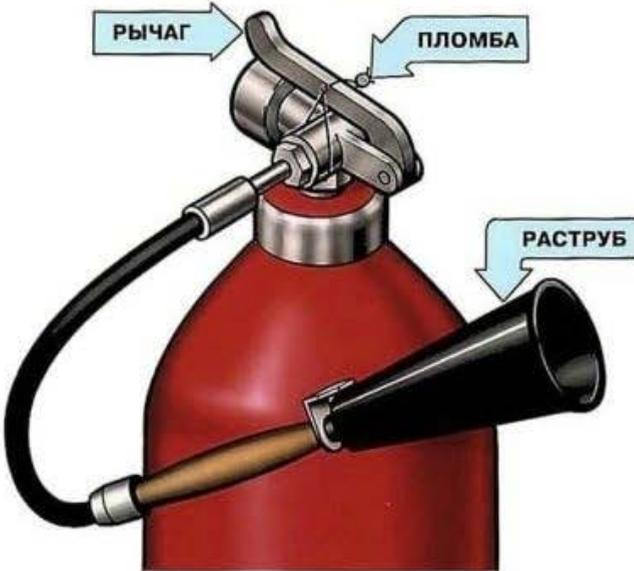
**ПРИНЦИП ДЕЙСТВИЯ** основан на вытеснении диоксида углерода избыточным давлением. При открывании запорно-пускового устройства  $\text{CO}_2$  по сифонной трубке поступает к раструбу и из сжиженного состояния переходит в твердое (снегообразное). Температура резко (до  $-70^\circ\text{C}$ ) понижается. Углекислота, попадая на горящее вещество, изолирует его от кислорода.
